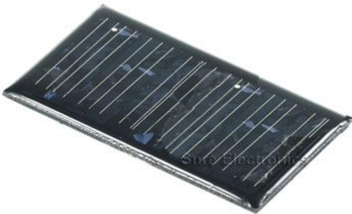
Confezione contenente 2 celle fotovoltaiche dalle dimensioni estremamente ridotte, ideali per effettuare esperimenti con l'energia solare. Tensione di uscita: 3,84 V, corrente massima: 55 mA, dimensioni: 68 x 35 mm, peso: 50 grammi.
