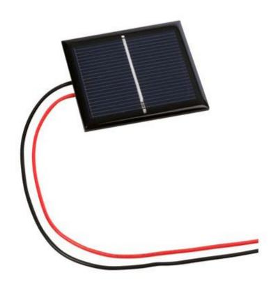
Pannellino fotovoltaico dalle dimensioni estremamente ridotte, ideale per effettuare esperimenti con l'energia solare. Tensione di uscita: 1 V, corrente tipica: 200 mA, dimensioni (mm): 46x40x2, lunghezza cavetti: circa 20 cm, peso: 9 grammi.
