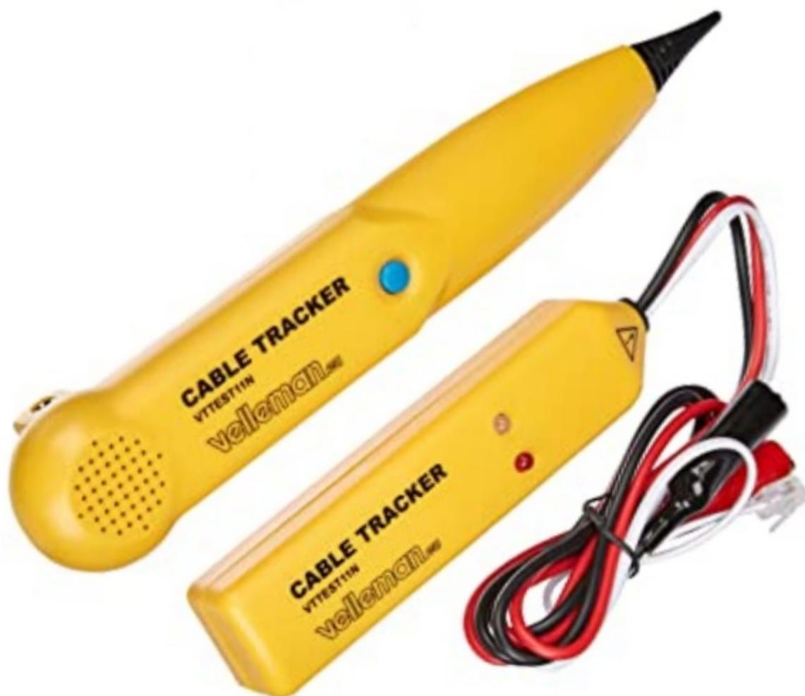
Tester per l'individuazione di cavi composto da una sonda e da un generatore di segnale. Permette di individuare in una matassa di cavi le estremità di un conduttore e di individuarne eventuali interruzioni. Il generatore di tono (forma d'onda quadra) può emettere un segnale continuo (1500 Hz) o intermittente (1300 - 1700 Hz). Modalità di segnalazione: luminoso (L), speaker (SP) o insieme (S & L). Completo di custodia.
