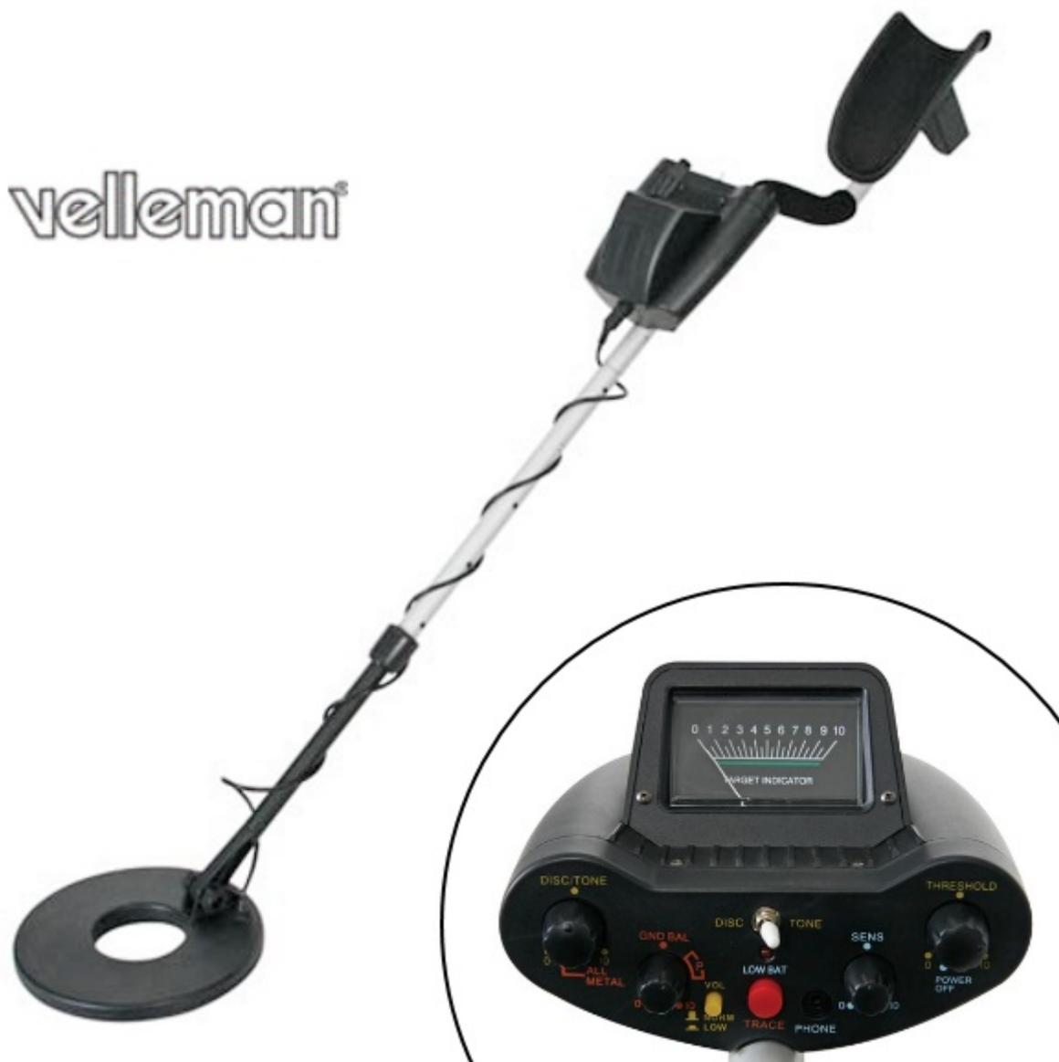
Cercametalli in grado di rilevare la presenza di oggetti metallici. Dotato di sonda a tenuta stagna da 215 mm, strumento a lancetta, discriminatore degli oggetti metallici non significativi (funzione notch), discriminatore audio a toni, controllo della sensibilità, modalità 'all metal' in grado di rilevare tutti i tipi di metalli, uscita per cuffia e indicatore di batteria scarica. Lunghezza dell'asta regolabile.
