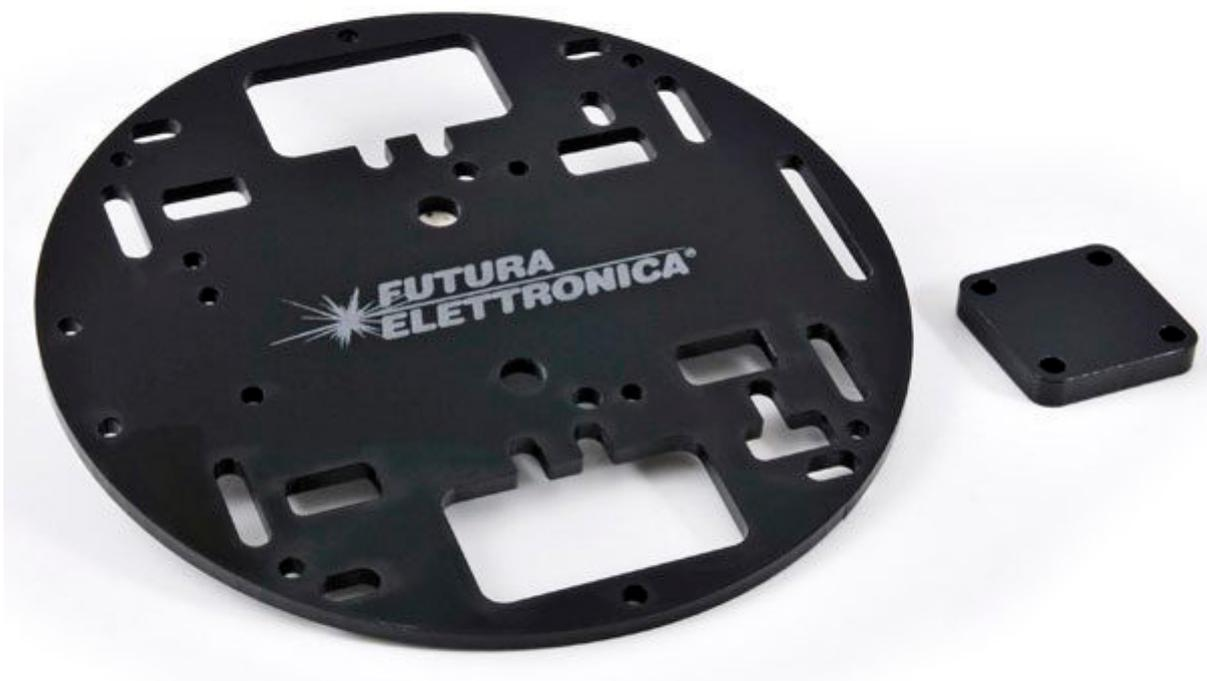
Chassis in plexiglass di colore nero tagliato al LASER con logo Futura Elettronica, il suo diametro (circa 12,7 cm) è poco più grande di un CD, dispone di molti fori e scanalature per il montaggio di Arduino Uno, sensori, motori (in particolare DGEARBOX), ruote, ball caster (BCASTER) e altro. Ideale per la costruzione di piccoli robot con due ruote. **Attenzione!** la confezione comprende solo lo CHASSIS nero, per gli accessori vedere prodotti correlati.
