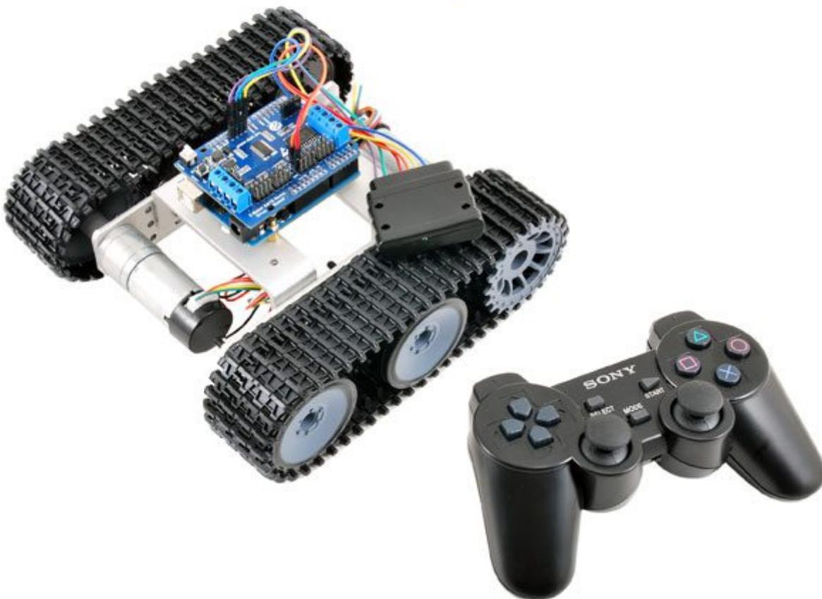
Set composto da un telaio in lega di alluminio, 2 cingoli larghi 45 mm, 2 motoriduttori con encoder ad effetto di Hall, una scheda Arduino compatibile, uno shield per 2 motori DC e 16 servi RC, un modulino con buzzer, un controller wireless a 2,4 GHz (compatibile Playstation 2) con il relativo ricevitore, 1 set di 40 cavetti femmina-femmina, un portabatteria per 2 batterie Li-Ion 18650 3,7V (non comprese) e un cavetto USB.
