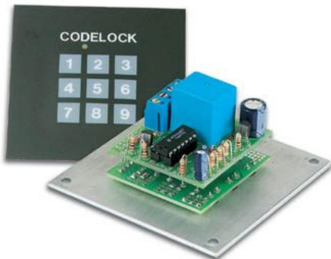
Questa chiave a tastiera può essere usata per attivare o disattivare un allarme (per esempio il kit K3504-Allarme auto), o per aprire un'elettroserratura. Un LED posizionato sul pannello frontale indica la posizione della chiave (aperto/chiuso). Il codice è facile da definire. Grazie al fatto che il pannello frontale è completamente chiuso, la chiave può essere utilizzata sia dentro ma anche fuori la casa.
