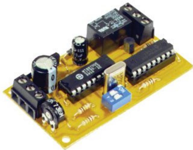
Questo dispositivo permette di controllare un carico elettrico mediante i normali toni DTMF. Funziona via filo, con apparati radio VHF/UHF, CB, ed anche con i telefoni cellulari.
