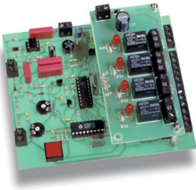
Scheda per il comando a distanza mediante codici espressi con sequenze in multifrequenza; collegabile alla linea telefonica oppure all'uscita di un apparato radio RTX, può essere attivata semplicemente da un telefono o da una tastiera DTMF del tipo usato per le segreterie. Il kit comprende tutti i componenti, la basetta forata e serigrafata e il microcontrollore programmato.
