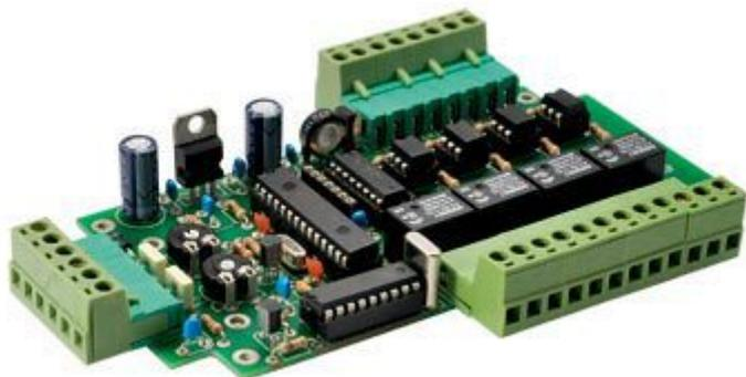
Collegata alla linea telefonica, è in grado di riconoscere dei comandi, impartiti tramite bitoni DTMF, e di controllare quattro carichi di potenza. Risponde automaticamente all'arrivo di una chiamata ed identifica il chiamante attraverso una password.
