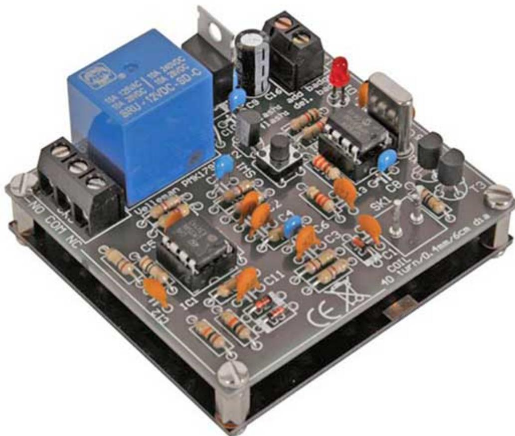
Chiave RFID ad alto grado di sicurezza con relè d'uscita attivabile, in modo temporizzato o bistabile (On/Off), avvicinando un transponder di quelli precedentemente memorizzati (fino a 25 transponder). Il kit comprende tutti i componenti, la basetta forata e serigrafata, la bobina di lettura e due transponder formato card. Alimentazione: 12 Vdc / 100 mA, dimensioni: 66 x 62 x 20 mm. **Attenzione!** i TAG compatibili con questo prodotto sono solo quelli presenti nei prodotti correlati (TAG 2).
