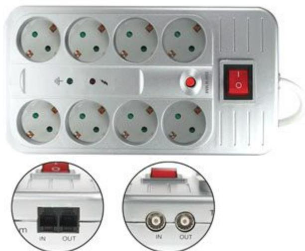
Ciabatta di alimentazione dotata di protezione contro le sovratensioni (LED rosso), protezione termica da sovraccarico (con ripristino manuale) e filtro EMI/RFI. Dispone di otto prese SCHUKO, connettore IN e OUT per antenna TV e per telefono, LED verde indicatore di messa a terra e interruttore ON/OFF con indicazione luminosa. Lunghezza del cavo 1,5 m. Carico massimo: 3500 Watt.
