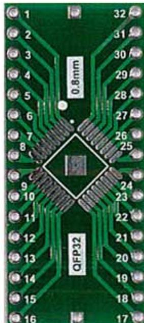
Circuito stampato adattatore per chip con case da QFP32 passo 0,8 mm a DIP32. Dimensioni (mm): 40,60x17,8.
