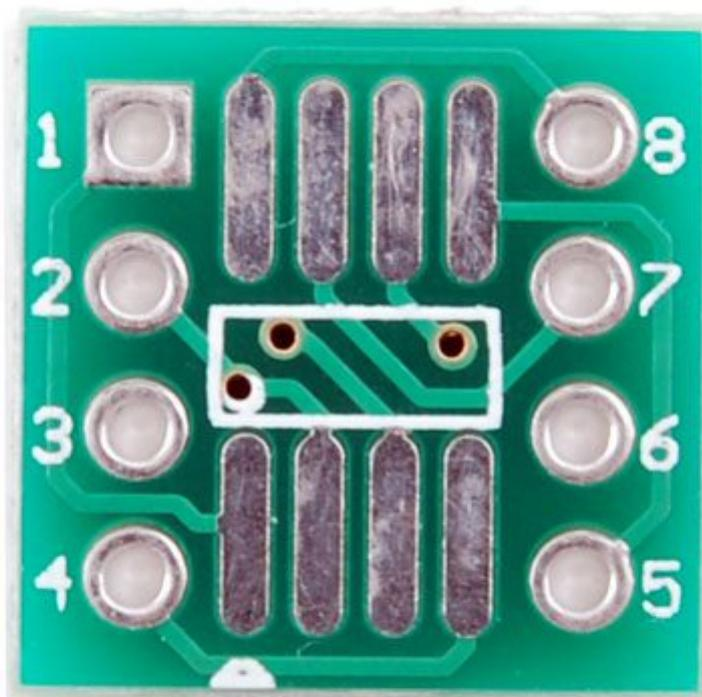
Piccolo circuito stampato che permette di adattare componenti con case SOP8 a DIP8. Dimensioni (mm): 11x11.
