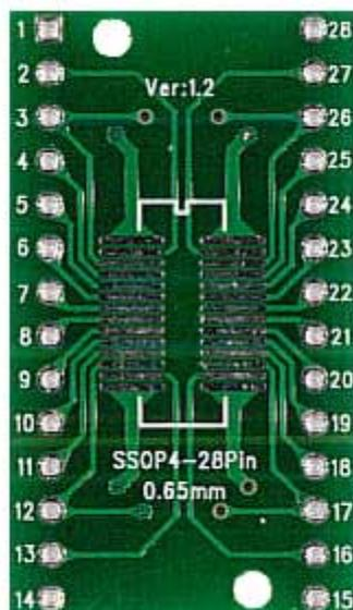
Circuito stampato che rende disponibili i pin dei chip con case da SSOP4 a SSOP28 passo 0,65 mm e da SOP4 a SOP28 passo 1,27 mm. Dimensioni (mm): 35,4x20,2.
