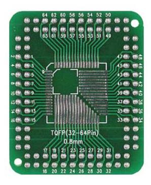
Circuito stampato che rende disponibili i pin dei chip con case da TQFP32 a TQFP100 passo 0,5 mm e da TQFP32 a TQFP64 passo 0,8 mm. Dimensioni (mm): 46x38.
