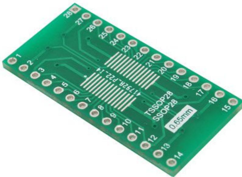
Piccolo circuito stampato che permette di adattare componenti con case TSSOP28-SSOP28 a DIP28. Dimensioni: 35,63 x 17,77 mm.
