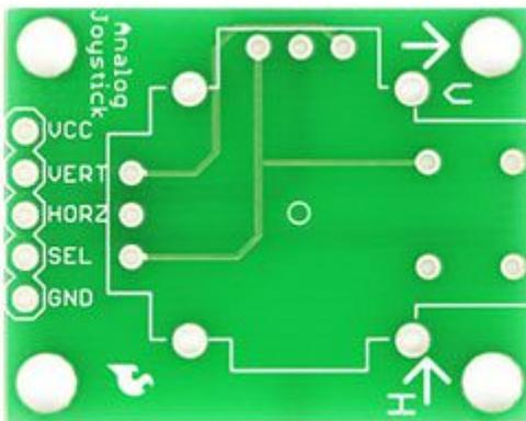
Circuito stampato realizzato appositamente per il joystick da c.s. (7300-CSJOYSTICK).
