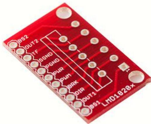
Circuito stampato realizzato appositamente per il chip LMD18200 e LMD18201 (DRIVER DI POTENZA 3A-55V - H-BRIDGE). Dimensioni: 30,44 x 18,96 mm. Dispone di due fori di fissaggio. **N.B.** il chip LMD1820 non è compreso.
