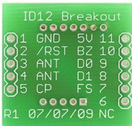
Semplice circuito stampato per il modulo RFID 8300-ID12. Dimensioni: 25,5 x 26,5 mm.
