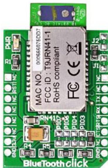
Bluetooth Click™ board è un modulo con fattore di forma [mikroBUS™](#). Permette di aggiungere la capacità bluetooth, con una portata di 100 metri, ai vostri dispositivi. Si basa sul modulo RN-41 con interfaccia UART e utilizza come alimentazione 3,3 Vdc. Dimensioni (mm): 39,7x25,7x12x6, peso: 25 grammi.
