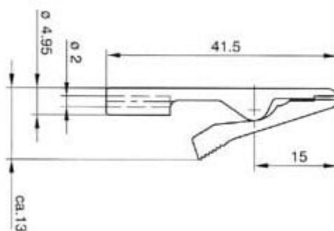
Pinza miniatura a cocodrillo completamente isolata in grado di stabilire un perfetto contatto elettrico. Colore nero.
