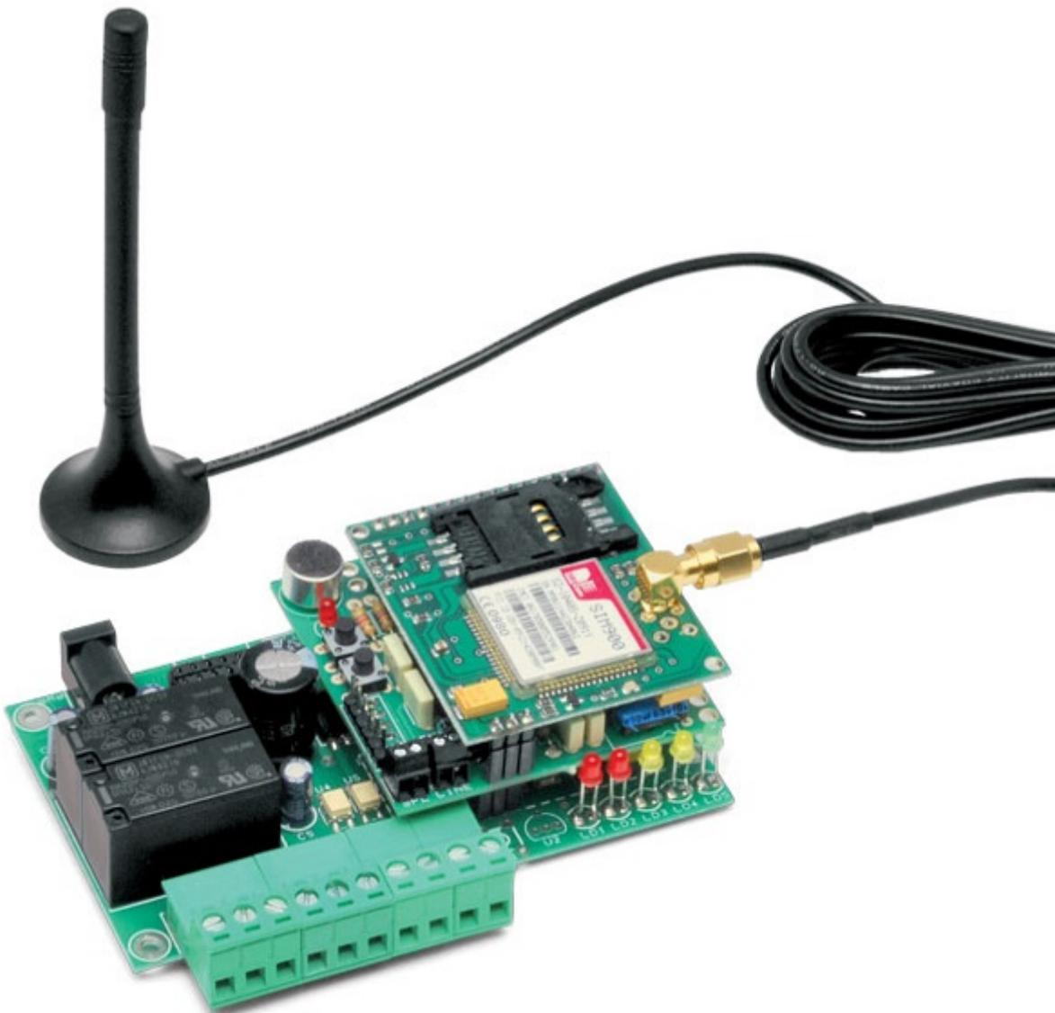
Dedicato al settore della sicurezza e dell'automazione a distanza, dispone di due ingressi optoisolati e di due uscite a relé (10A max) per carichi a bassa tensione. Le impostazioni possono essere gestite da remoto mediante SMS oppure in locale tramite PC con apposito software (necessario il driver USB FT782M e contenitore in ABS BOXTDG135 (opzionali)). **Il dispositivo sfrutta unicamente la rete GSM. Può pertanto lavorare senza problemi con SIM della compagnia Wind, TIM, Vodafone, ma non può**
