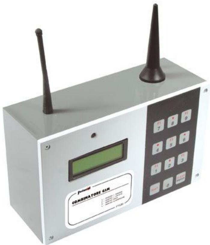
Combinatore telefonico GSM adatto a qualsiasi impianto antifurto; può essere attivato via radio, mediante un contatto o con una tensione. L'ingresso radio può essere abbinato ad un trasmettitore tascabile per teleassistenza. Completo di messaggistica vocale personalizzabile per ogni ingresso. Per completare il kit del combinatore è necessario acquistare separatamente la batteria tampone, le due antenne, il contenitore, l'alimentatore da rete e l'eventuale trasmettitore radio.
