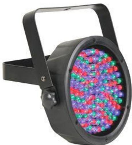
Compatto proiettore PAR56 dotato di 108 LED da 10 mm (36 rossi, 36 verdi, 36 blu) ad alta intensità luminosa. Miscelazione colori RGB. Modalità di funzionamento: DMX 3 canali (RGB) o 7 canali (RGB - macro - strobo), master / slave e controllo musicale. Diametro 184 mm - spessore 55 mm.
