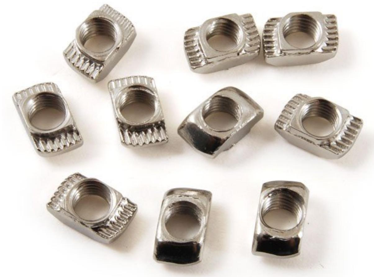
Dado in acciaio con testa a martello e foro filettato M3 adatto per le scanalature da 6 mm dei profili in alluminio serie 2020. Questo elemento di fissaggio può essere inserito nella cava del profilato anche a posteriori in sistemi preesistenti. Il bloccaggio del dado avviene automaticamente durante il serraggio della vite inserita che ne provoca la rotazione di 90° all'interno della cava.
