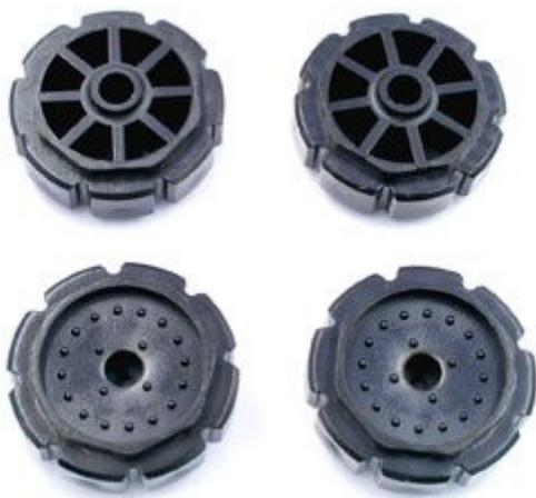
Set costituito da quattro robuste ruote dentate in ABS nero, due delle quali specifiche per montaggio sugli alberi motore da 7 mm dei motoriduttori GM2, GM3 e GM9 e due ruote con foro centrale da 6,2 mm . Diametro esterno ruota: 38 mm . Ideali per realizzare cingoli per piccoli robot. Utilizzare con le maglie 7300-MLTP10 (non comprese).
