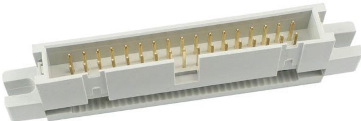
Connettore maschio a crimpare per flatcable da 40 pin ((2x20 Pin) con passo 2,54 mm. Adatto per fissaggio a pannello. Dimensioni (mm): 76x13x8, peso: circa 7,5 grammi, temperatura di funzionamento: da -40°C a +105°C.
