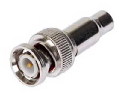
Connettore BNC "quick crimp" per cavi RG59/U con diametro esterno 6,2 mm e impedenza 75 ohm. Il connettore di tipo "quick crimp" è formato da due parti, il connettore BNC con già inserito il perno del conduttore centrale e dalla parte metallica che viene crimpata sulla calza del cavo.
