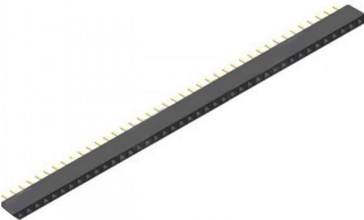
Connettore femmina da c.s. a 40 pin divisibile, passo 2.54 mm. Materiale contatti: bronzo fosforoso, portata contatti: 3 A, temperatura di lavoro: da -40°C a +105°C.
