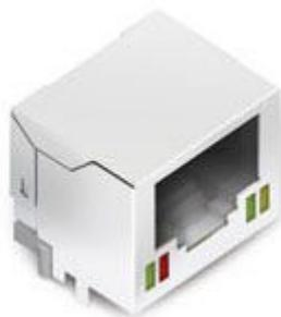
Connettore 100BaseT completo di filtri magnetici e 4 led per la segnalazione di stato. Dimensioni: 15,5 x 19 x 15,5 mm. Può essere utilizzato con qualsiasi modulo Tibbo non dotato di filtri.
