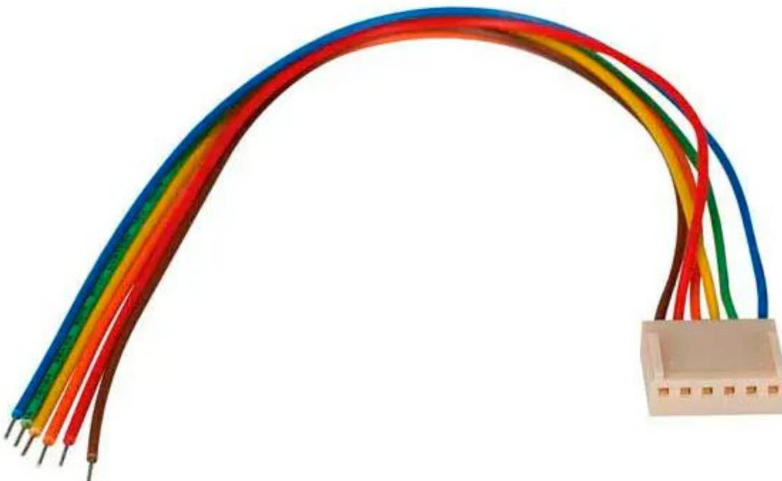
Connettore femmina a 6 poli con cavetti lunghi 20 cm, passo 2,54 mm, case in nylon 66 (UL94V-0), tensione nominale 50 Vdc max, corrente 3 A max.
