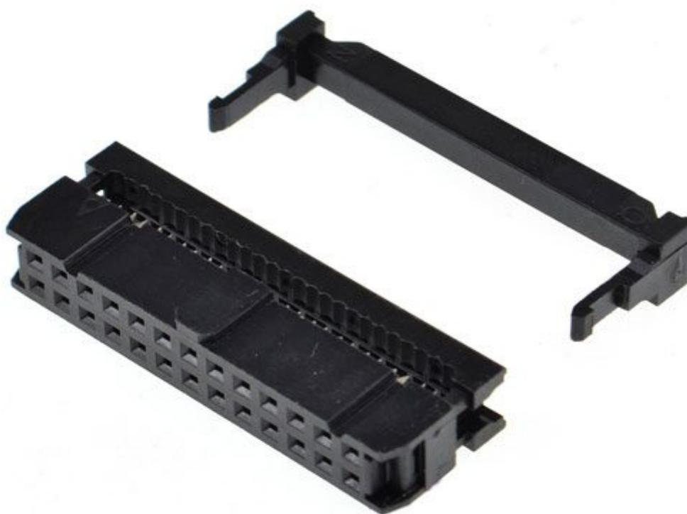
Connettore IDC femmina volante a crimpare per flatcable da 26 pin (2x13 Pin) con passo 2,54 mm. Dimensioni (mm): 37,62x18,3x6, peso: circa 10 grammi.
