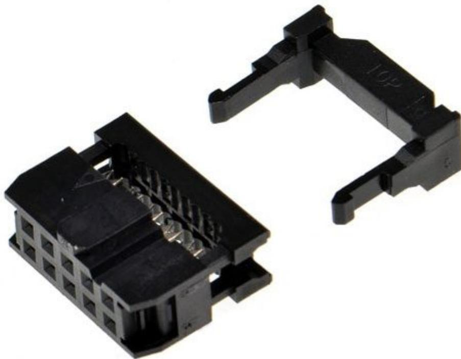
Connettore IDC femmina volante a crimpare per flatcable da 10 pin (2x5 Pin) con passo 2,54 mm. Dimensioni (mm): 17,3x18,3x6, peso: circa 5 grammi.
