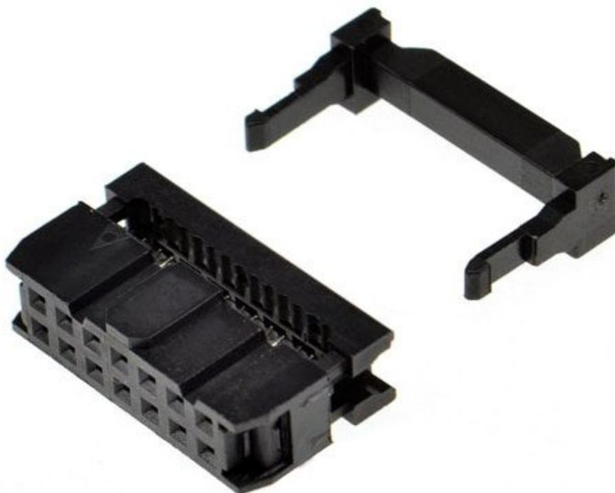
Connettore IDC femmina volante a crimpare per flatcable da 14 pin (2x7 Pin) con passo 2,54 mm. Dimensioni (mm): 22,38x18,3x6, peso: circa 5 grammi.
