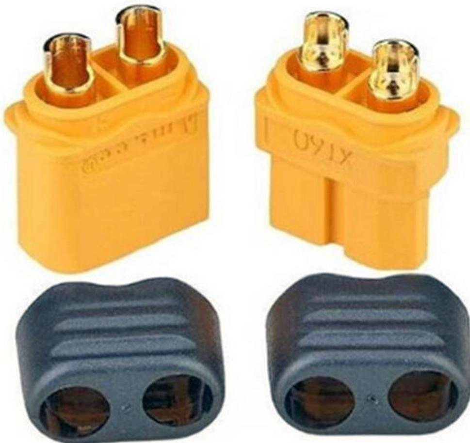
Confezione composta da un connettore maschio e femmina XT60 e relative protezioni per cavi. Utilizzato solitamente per il collegamento delle batterie LiPo, è adatto per fili con sezione 12AWG (circa 3,3 mm<sup>2</sup>), sopporta una corrente nominale di 60 A e una tensione nominale di 500 VDC. Temperatura di funzionamento: da -20°C a +120°C, classe di infiammabilità UL94V-0.
