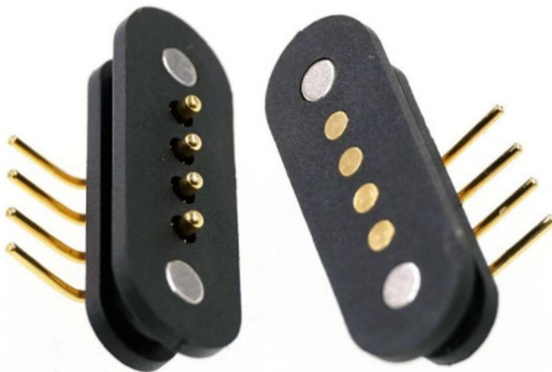
Coppia di connettori (maschio e femmina) per montaggio su circuito stampato, entrambi dotati di 2 piccoli potenti magneti e 4 pin a 90 gradi con passo 2,5 mm. Quando i connettori vengono avvicinati, i magneti di cui sono dotati si attraggono, accoppiando i due connettori e ottenendo un contatto sicuro tra i pin. Tensione: max. 36 Vdc, corrente: 2 A, resistenza d'isolamento: 500 Mohm, temperatura di lavoro: da -30°C a +65°C, dimensioni (mm): 21x7x4.
