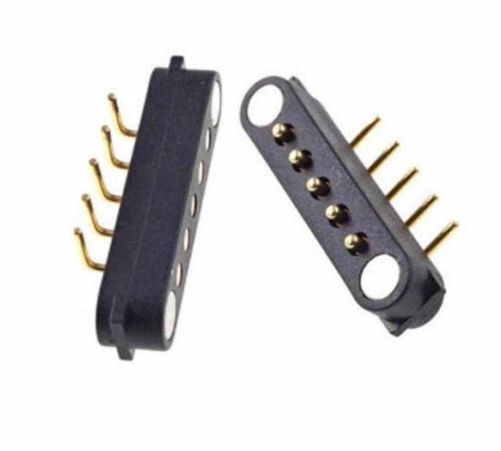
Coppia di connettori (maschio e femmina) per montaggio su circuito stampato, entrambi dotati di 2 piccoli potenti magneti e 5 pin a 90 gradi con passo 2,5 mm. Quando i connettori vengono avvicinati, i magneti di cui sono dotati si attraggono, accoppiando i due connettori e ottenendo un contatto sicuro tra i pin. Tensione: max. 36 Vdc, corrente: 2 A, resistenza d'isolamento: 500 Mohm, temperatura di lavoro: da -30°C a +65°C, dimensioni (mm): 20,08x4,2x4.
