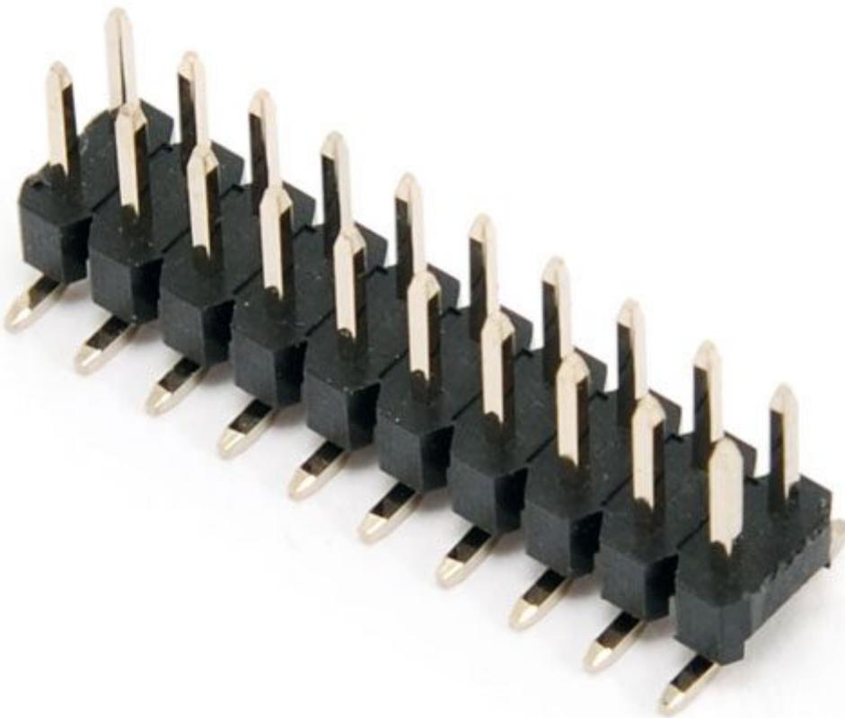
Connettore maschio 2x10 pin passo 2 mm. Materiale: bronzo fosforoso, Dimensioni: altezza 5,97mm, lunghezza 20 mm, montaggio SMT.
