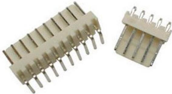
Connettore maschio 90° da circuito stampato, 6 poli passo 2,54 mm, case in nylon 66 (UL94V-0), tensione nominale 50 Vdc max, corrente 3 A max.
