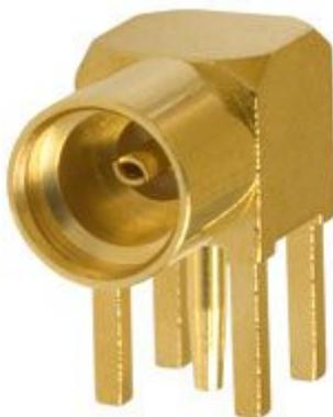
Connettore MMCX femmina a 90°, montaggio a saldare su circuito stampato. Temperatura di lavoro: da -40°C a +90°C, impedenza 50 ohm, frequenza da 0 a 6 GHz, VSWR  $\leq$  1.25, tensione di lavoro: 170V(rms), resistenza di isolamento:  $\geq$  1000Mohm. Resistenza di contatto: conduttore esterno  $\geq$  5Mohm - conduttore centrale  $\geq$  10Mohm, corpo in ottone placcato in oro.
