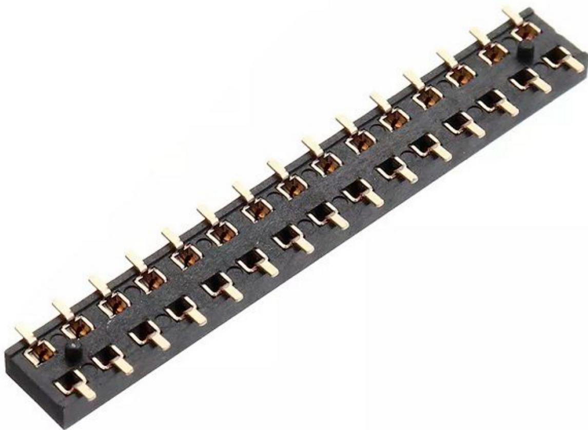
Connettore femmina 2x15 pin passo 2,54 mm particolarmente indicato per l'utilizzo con le schede della serie M5STACK e non solo. Materiale: bronzo fosforoso, Dimensioni (mm): 38x7x3, montaggio SMT.
