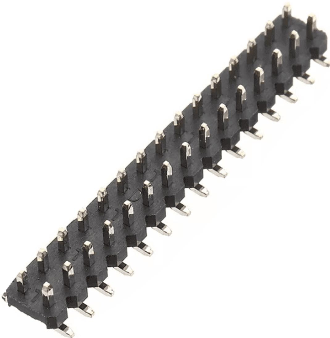
Connettore maschio 2x15 pin passo 2,54 mm particolarmente indicato per l'utilizzo con le schede della serie M5STACK e non solo. Materiale: bronzo fosforoso, Dimensioni (mm): 38x7x6, montaggio SMT.
