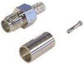
Connettore SMA femmina a crimpare utilizzato in sistemi in alta frequenza e adatto a cavi coassiali con diametro guaina 6 mm tipo RG58, RG59, RG223, ecc.
