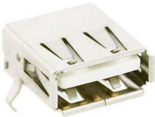
Connettore USB femmina tipo "A" con pin a montaggio superficiale (SMT). Dimensioni (mm): 14,4 (lunghezza) x 12,5 (larghezza) x 5,12 (altezza).
