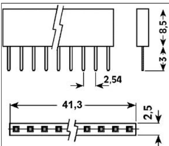
Connettore femmina da c.s. a 16 pin passo 2.54 mm. Materiale contatti: bronzo fosforoso, portata contatti: 3 A, temperatura di lavoro: da -40°C a +105°C.
