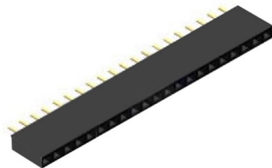
Connettore femmina da c.s. a 20 pin passo 2.54 mm. Materiale contatti: bronzo fosforoso, portata contatti: 3 A, temperatura di lavoro: da -40°C a +105°C.
