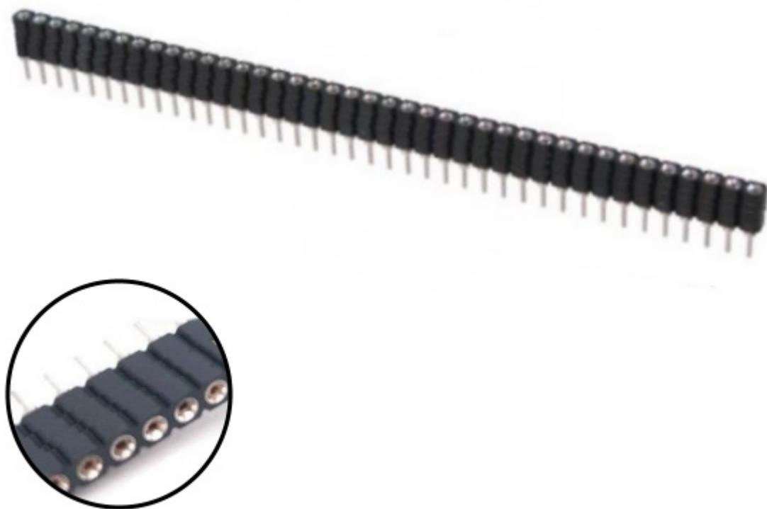
Connettore femmina da c.s. a 40 pin passo 2.54 mm. Materiale contatti: bronzo fosforoso, portata contatti: 3 A, temperatura di lavoro: da -40°C a +105°C.
