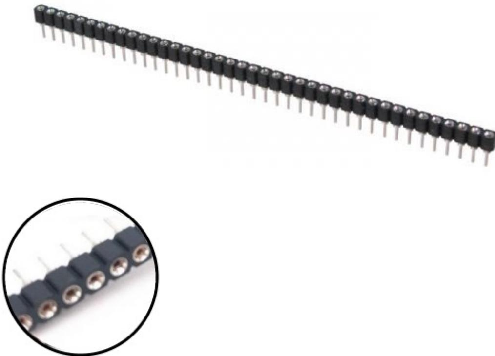
Connettore femmina da c.s. a 40 pin passo 2.54 mm. Singola linea, contatti sezionabili, pin circolari. Portata contatti: 1 A, temperatura di lavoro: da -40°C a +105°C.
