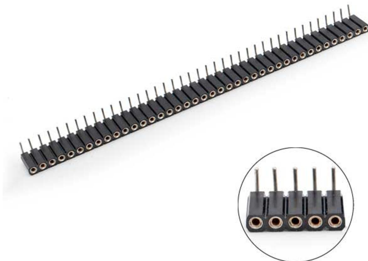
Connettore strip femmina da circuito stampato a 40 pin torniti con passo 2.54 mm e inclinazione a 90°. Singola linea, contatti sezionabili.
